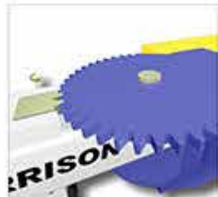
sistema rotación de torre
